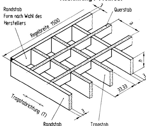
Bezeichnung eines einzelnen Gitterrostes, ausgeführt als Schweißpreßrost (SP) von Tragstabhöhe  $h = 40$  mm, Querstabteilung  $a = 38,1$  mm, Länge in Tragstabrichtung  $T = 800$  mm und Breite  $1000$  mm:
